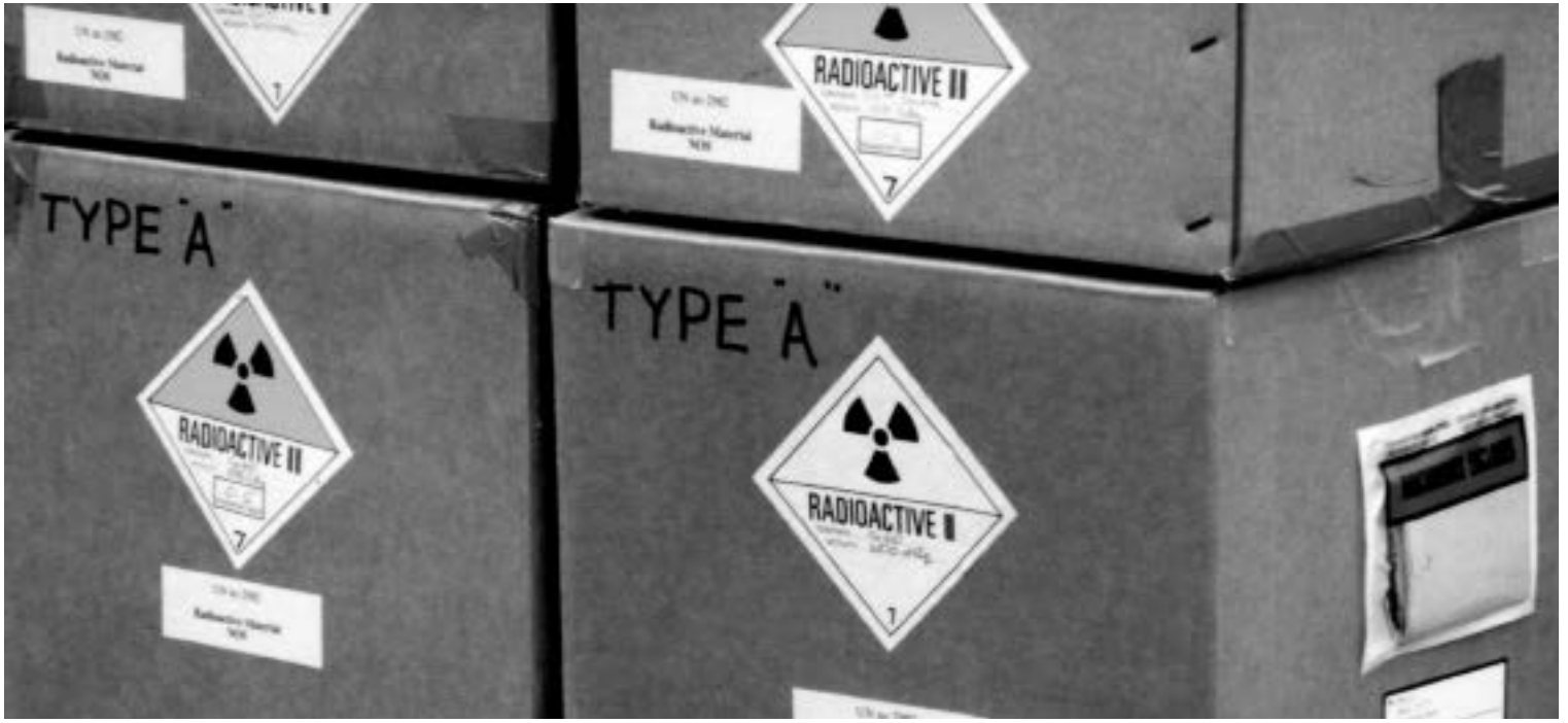
تخزين مواد التفتحة المستخدمة لإحتواء المواد الإشعاعية، مثل تلك الصناديق، بتعرضها للضغط أثناء تطويرها. كتيب الصور للوكالة الدولية للطاقة الذرية IAEA.org
